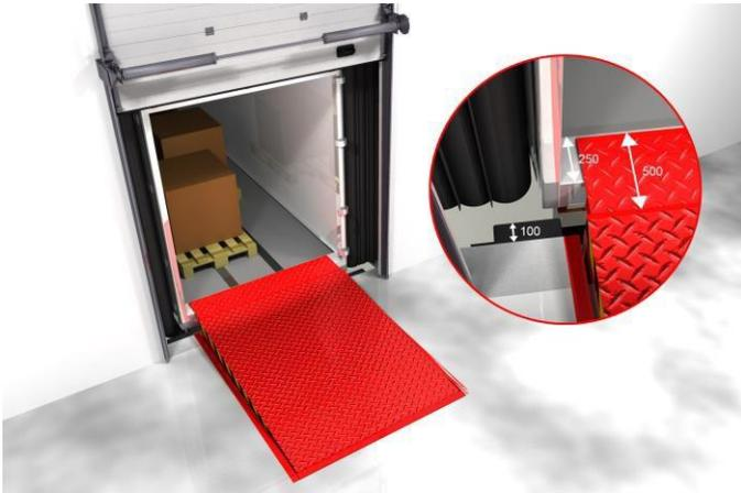
Niveleur de quai électro-hydraulique avec bavette télescopique. L'entraînement du plateau et de la bavette est hydraulique.
